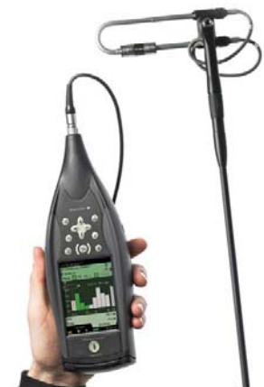
Abb. 12 - Brüel & Kjær Schallintensitäts-Mess-System 2270G mit 2-Mikrofon-Sonde
