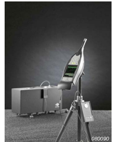
Abb. 16 Messausrüstung für Trittschallmessungen
