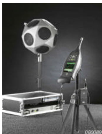
Abb. 6 Messausstattung für Schalldämmungsmessungen
